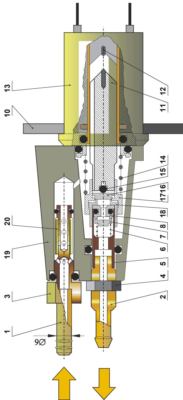
1 - штуцер подвода топлива; 2 - штуцер отводной; 3 - корпус фильтра; 4 - гайка M10x1; 5 - плунжер; 6 - пружина нагнетающего клапана; 7 - нагнетающий клапан; 8 - седло нагнетающего клапана; 10 - фланец крепления топливного насоса; 11 - якорь электромагнита; 12 - упор; 13 - элекромагнит; 14 - пружина якоря; 15 - упор якоря; 16 - всасывающий клапан; 17 - зацеп; 18 - втулка; 19 - корпуш; 20 - сетка фильтра.
