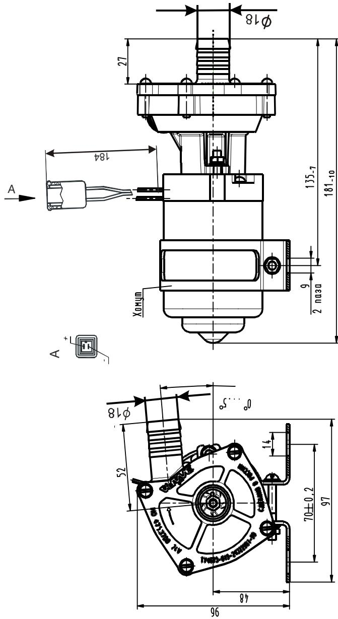
Рисунок 8 - Электронасос жидкостный
