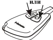
Если через 1 сек светодиод загорается и в течение 3 сек мигает оранжевым светом - **заряд батареек понижен**: отогреть их до температуры выше 0°C и при первой возможности заменить.
